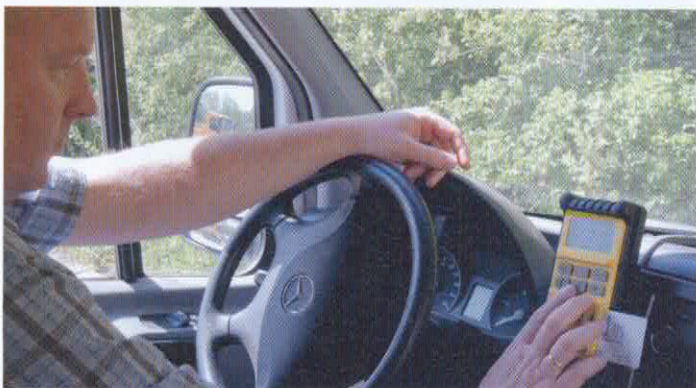
Bild 1: Über die Car-Station können die Daten von der Baustelle direkt an die Zentrale übermittelt werden
