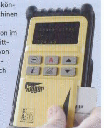
Bild 3 und 4: Der Logger ist mit Akkus versehen und kann netzunabhängig auf jeder Baustelle betrieben werden
